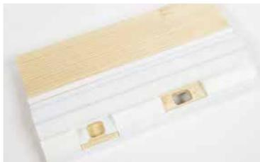
Le cadre (bâti) du côté poignée est machiné afin de recevoir les deux gâches qui permettent le passage des deux pènes.
